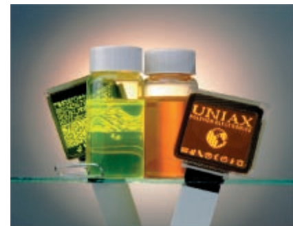
Figura 7: Mostruário de materiais eletroluminescentes usados pela Uniax para produzir LED multicoloridos.
