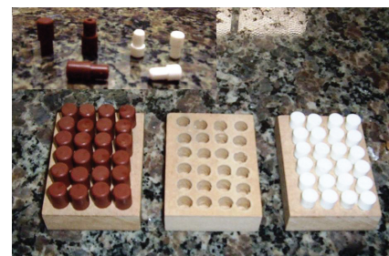
Figura 1: Três placas de madeira do tipo MDF utilizadas para a representação da placa metálica: a primeira preenchida com pinos marrons; a segunda, sem pinos; e a terceira, com pinos brancos. Em detalhe, no canto superior esquerdo, apresenta-se a fotografia dos pinos tipo “pitão” de cores e tamanhos diferentes.
