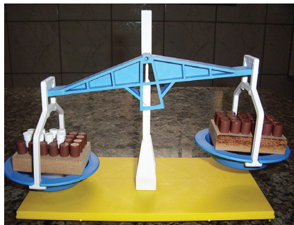
Figura 3: Representação de uma deposição não espontânea na qual ocorre a cobertura da superfície metálica por outro metal, aumentando assim a massa da placa e a característica da superfície.
