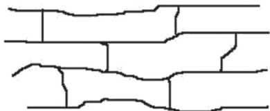
Figura 8: Representação simplificada de cadeias poliméricas reticuladas.
