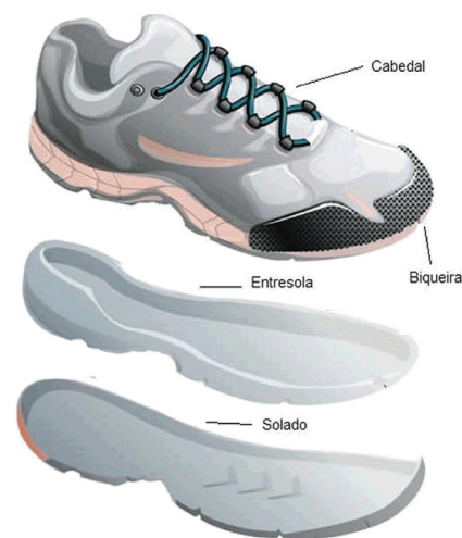
Figura 1: Partes constituintes do tênis.
