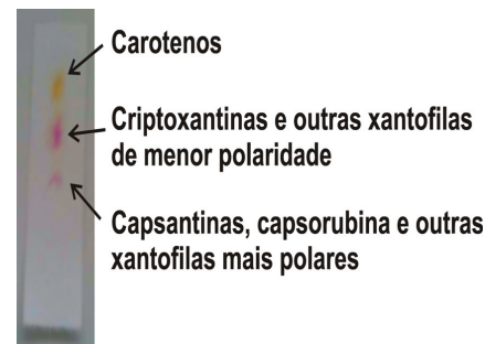
Figura 5: Cromatograma do extrato de pimentão vermelho, utilizando thinner e removedor de esmalte para unhas.
