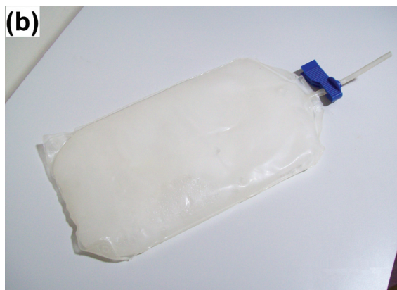
Figura 3: Bolsa de acetato de sódio produzida no CECIMIG, antes (a) e depois da cristalização (b).
