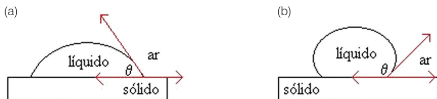
Figura 2: Superfícies hidrofílicas (a) apresentam ângulo de contato menores que 90^\circ , enquanto superfícies hidrofóbicas (b) apresentam ângulos maiores que 90^\circ .
