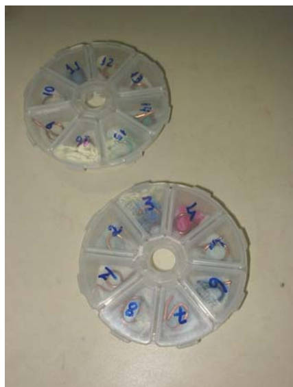
Figura 1: Sistema para o ensaio de corrosão em cobre.
