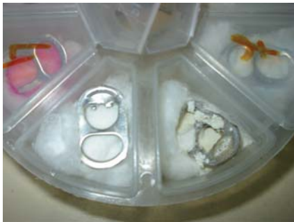
Figura 3: Amostras de alumínio após uma semana de ensaio. Na direita, tem-se o produto 6 e, na esquerda, o produto 5.
