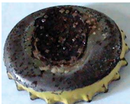
Figura 4: Ferrugem na tampinha após 24 h.
