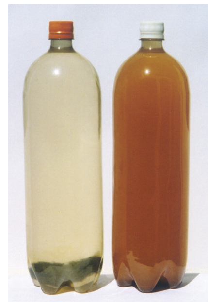
Figura 2: Na garrafa à esquerda (com borbulhamento de argônio) não houve formação significativa de ferrugem devido à redução no nível de OD. Na garrafa à direita, na qual não foi borbulhado argônio, nota-se significativa formação de ferrugem, indicando níveis altos de OD na amostra.
