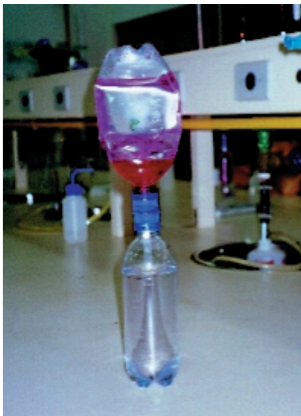
Figura 2: Montagem experimental do chariz de amônia com o sistema colapsado, após brusca queda da pressão interna.
