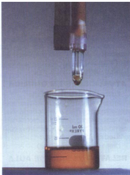
Foto 2: Separação cromatográfica de pigmentos de anilina em coluna feita com mangueira e tubo de caneta.
